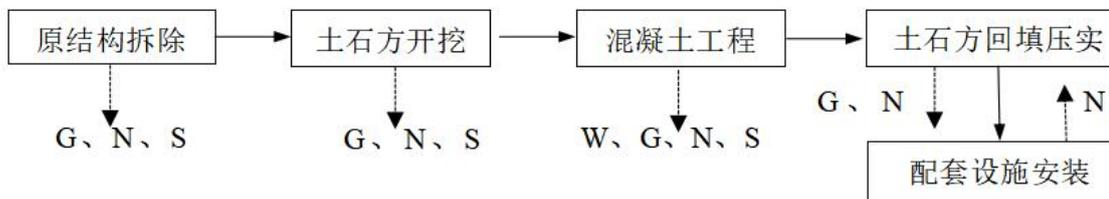
图4-1 放水设施施工流程图
