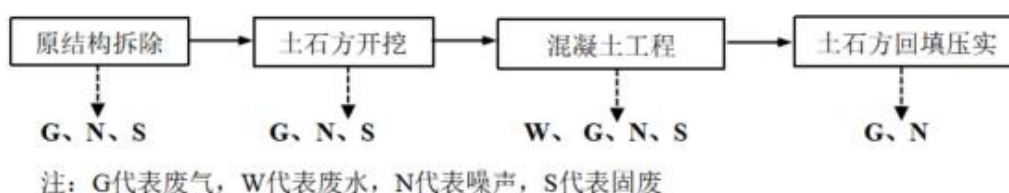
图 4.5-3 溢洪道、交通桥施工流程图
